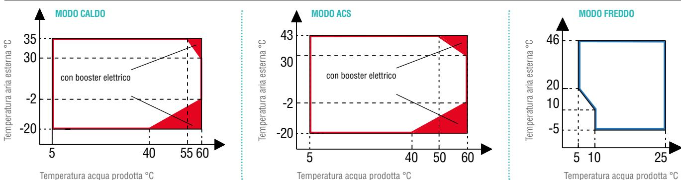
**NOTA MODO ACS:** Per temperatura acqua prodotta si intende la temperatura acqua prodotta dall'unità e non la temperatura ACS disponibile all'utente che è funzione di questo parametro e della superficie del serpantino del bollitore ACS.
