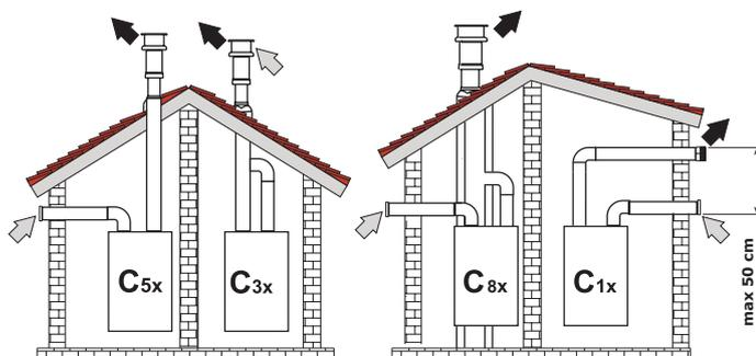
Fig. 3 - Esempio di collegamento con tubi separati
