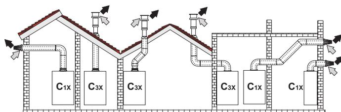
Fig. 2 - Esempio di collegamento con tubi coassiali
