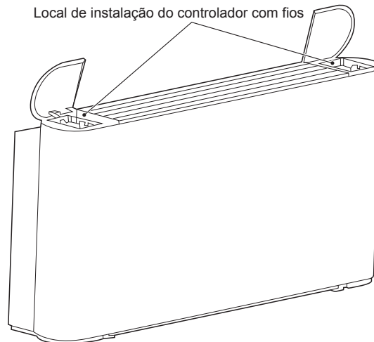
Figura 3-1 Posição de instalação do controlador com fios
